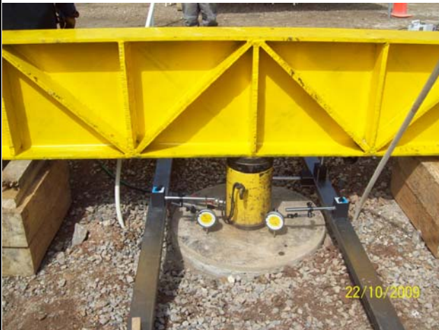
Figura 11. Ejecución de la prueba de módulo de carga en una Pila de Agregado Compactado.
